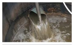
El sensor SulfiLogger™ colocado directamente en las aguas residuales crudas en la entrada del pozo.
