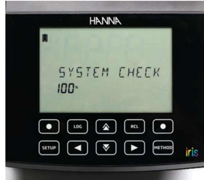
El chequeo óptico automático al iniciar el equipo para el aseguramiento de la calidad de la medida óptica, antes de las medidas.
