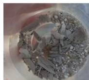
Gránulos de estruvita de diferente tamaño con impurezas y escamas de estruvita de la pared del reactor - escurridos deshidratación
