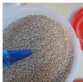
Muestra estruvita seca sin impurezas 0,5-2 mm - sobrenadante
