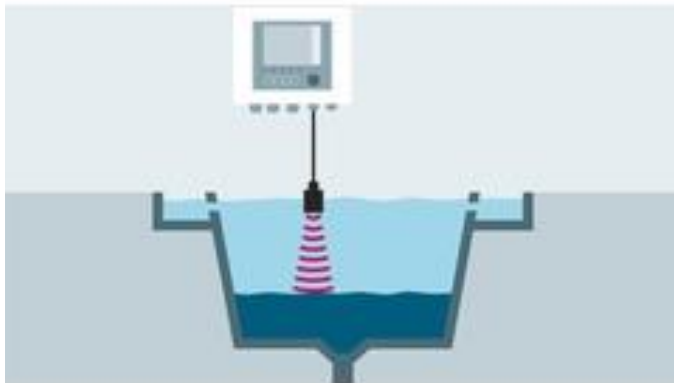
Sondas de Nivel del manto de Fango
