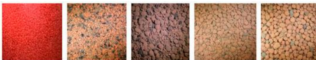
Figura (4). Ejemplo de gránulos ANAMMOX® granules: solo AMX (izq) y PN/AMX (4 × dcha) con diámetros típicos de 1, 1–2, 2–5, 3–5, and 4–6 mm, respectivamente [2]
