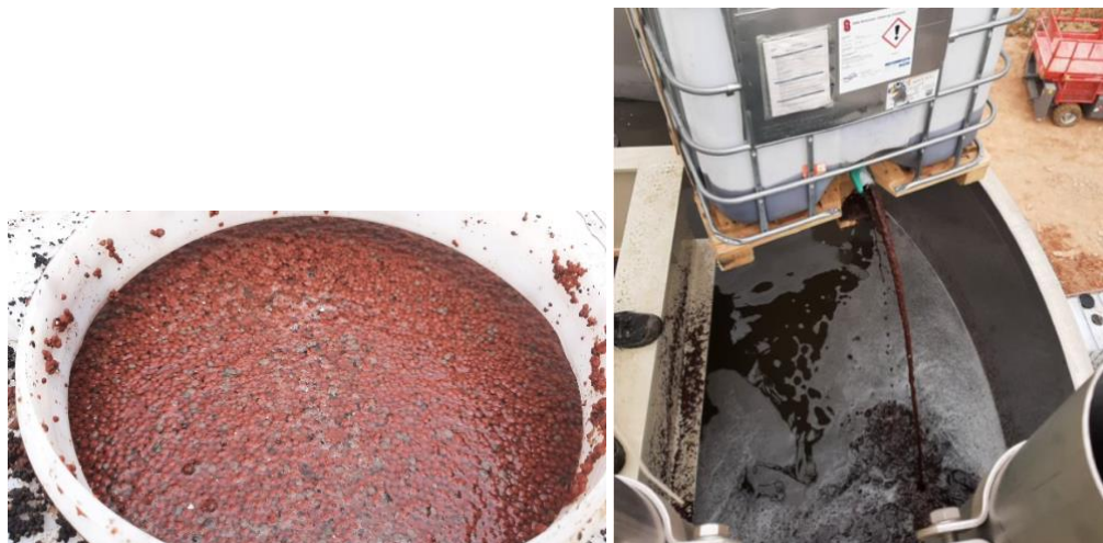
Figura (9). Foto de la siembra del reactor y detalle de los gránulos de biomasa NP/A sembrados en el reactor de Rubí
