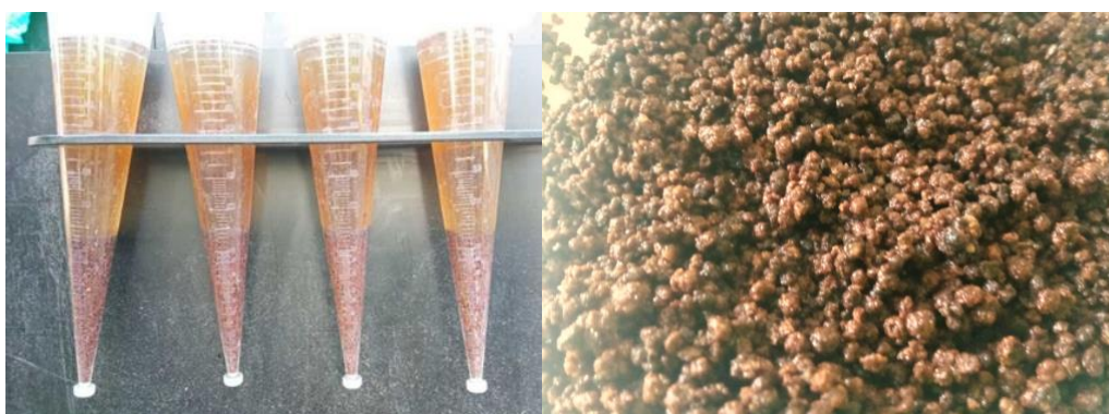
Figura (5). - Detalles de los conos Imhoff y de los gránulos de biomasa del interior del reactor tras la siembra en Julio 2023
