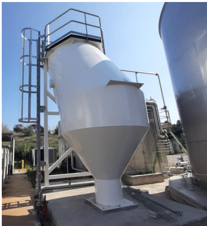
Figura (4). - Detalle del decantador Astraseparator®
